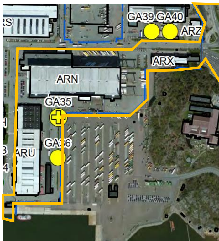
Figur 5. Karta visar undersökningspunkter inom planområdet. Gul färg på punkten indikerar föroreningshalter av metall och petroleumkväten över KM. Kors indikerar föroreningshalter av kvicksilver över KM (Golder, 2016).
